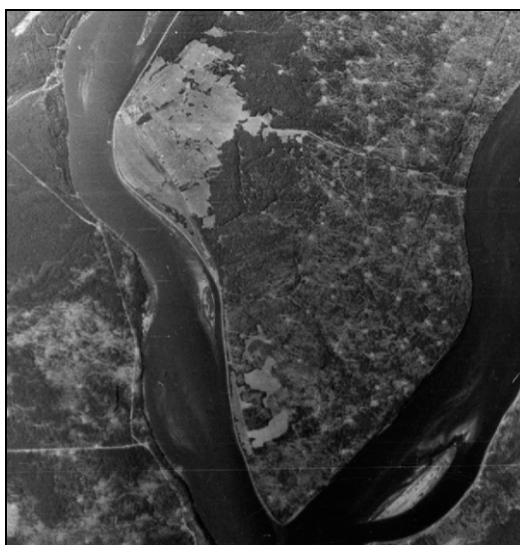
Рис. 3. В таком состоянии было днище Усть-Илимского водохранилища непосредственно перед заполнением. Как видно, произведена только выборочная рубка леса. Аэрофотоснимок 1973 г.
