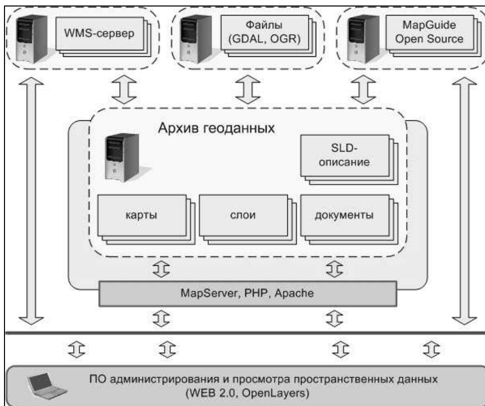
Рис. 2. Структурная схема Интернет-каталога пространственных данных.
