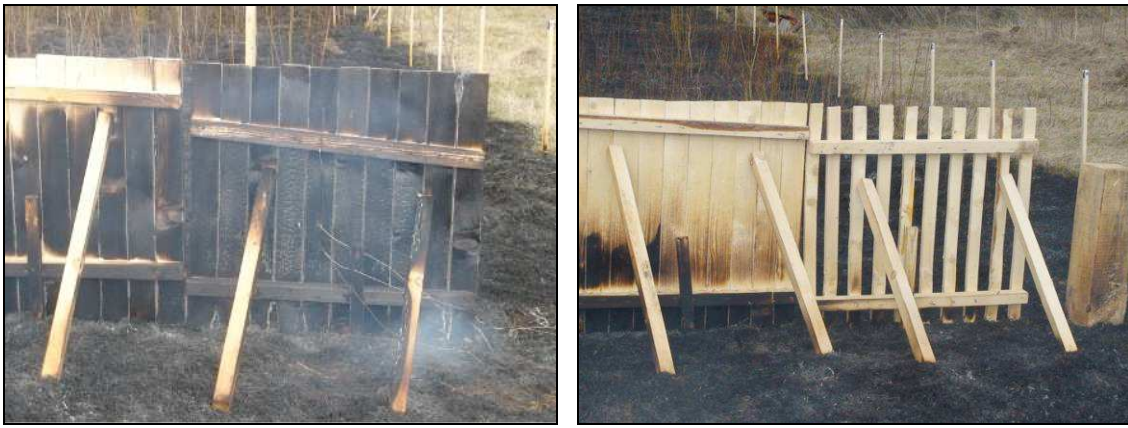
Рис. 5. Результаты воздействия степного пожара на деревянные щиты.
