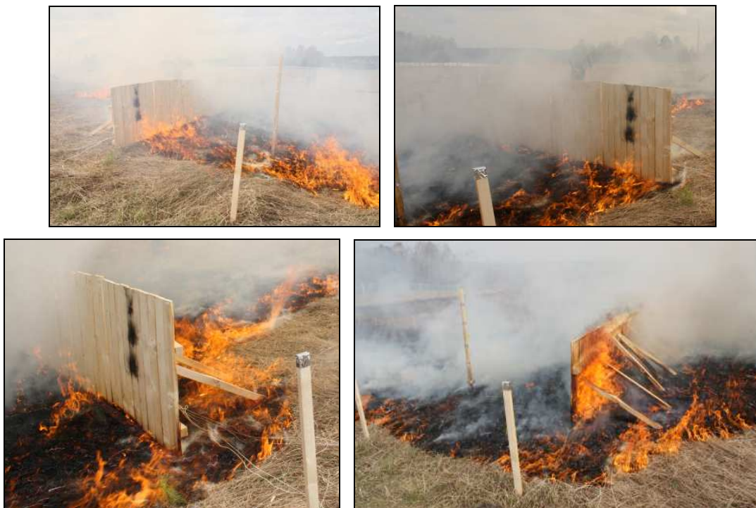
Рис. 4. Воздействие фронта степного пожара на деревянные щиты.
