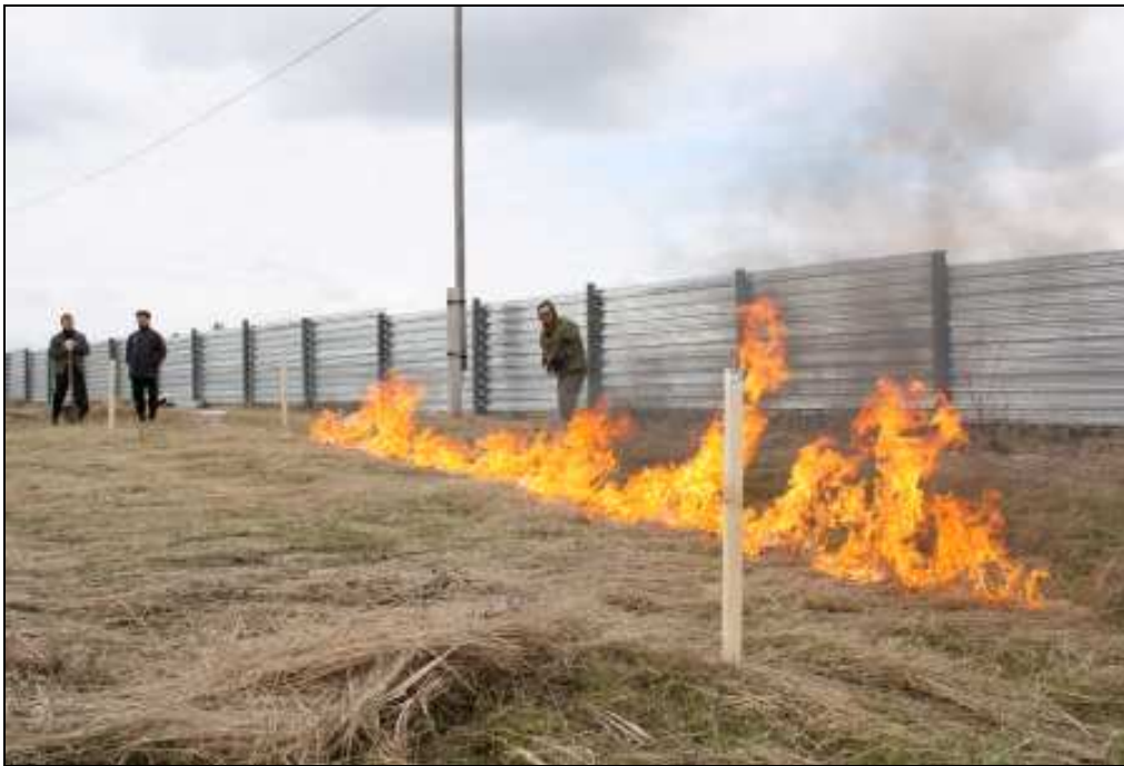
Рис. 3. Зажигание экспериментальной площадки.
