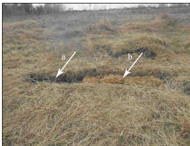
Рис. 2. Вид уложенных образцов торфа на экспериментальной площадке: а – низинный тип торфа, б – вершинный тип торфа.
